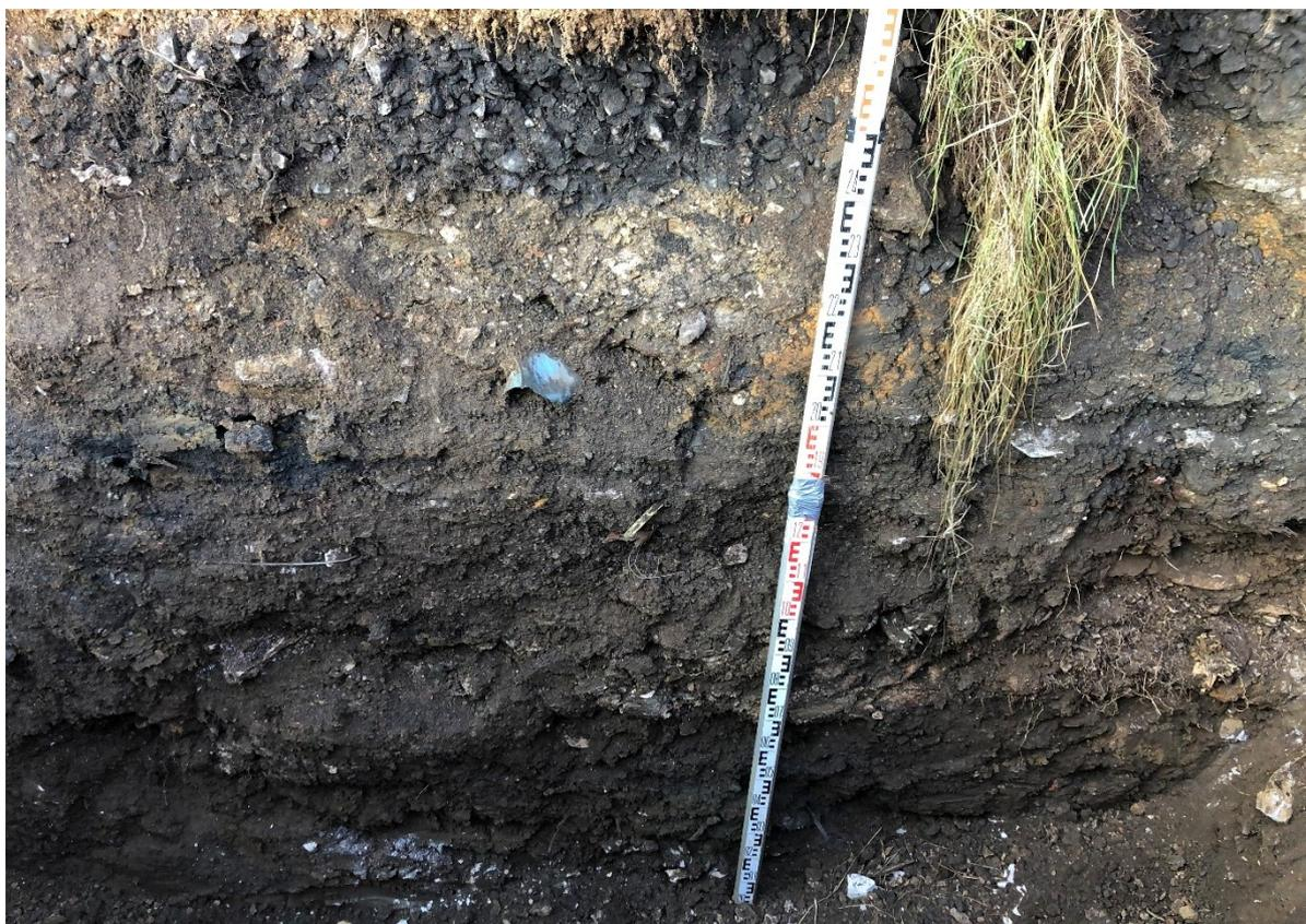
Figure 32 – Photographies des opérations de fouilles à la pelle en préparation des essais d'infiltration
