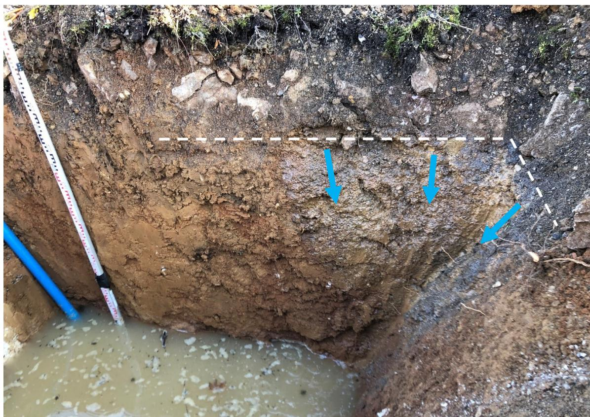
Figure 36 – Illustration des percolations à l'interface remblais/argiles de décalcification entre la fouille F1 et F2.
