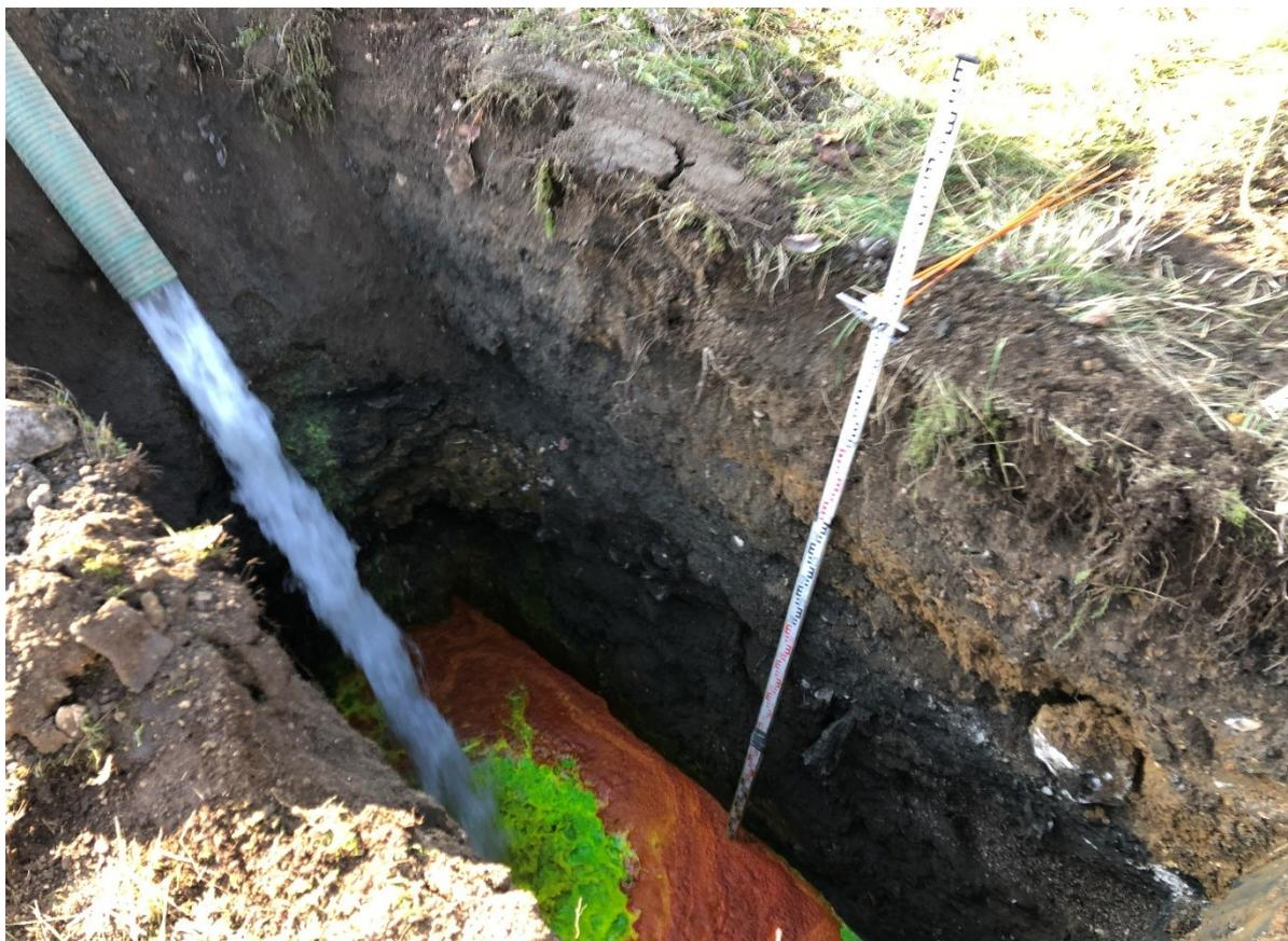
Figure 13 – Photographies des opérations d'injection de traceur au point n°1
